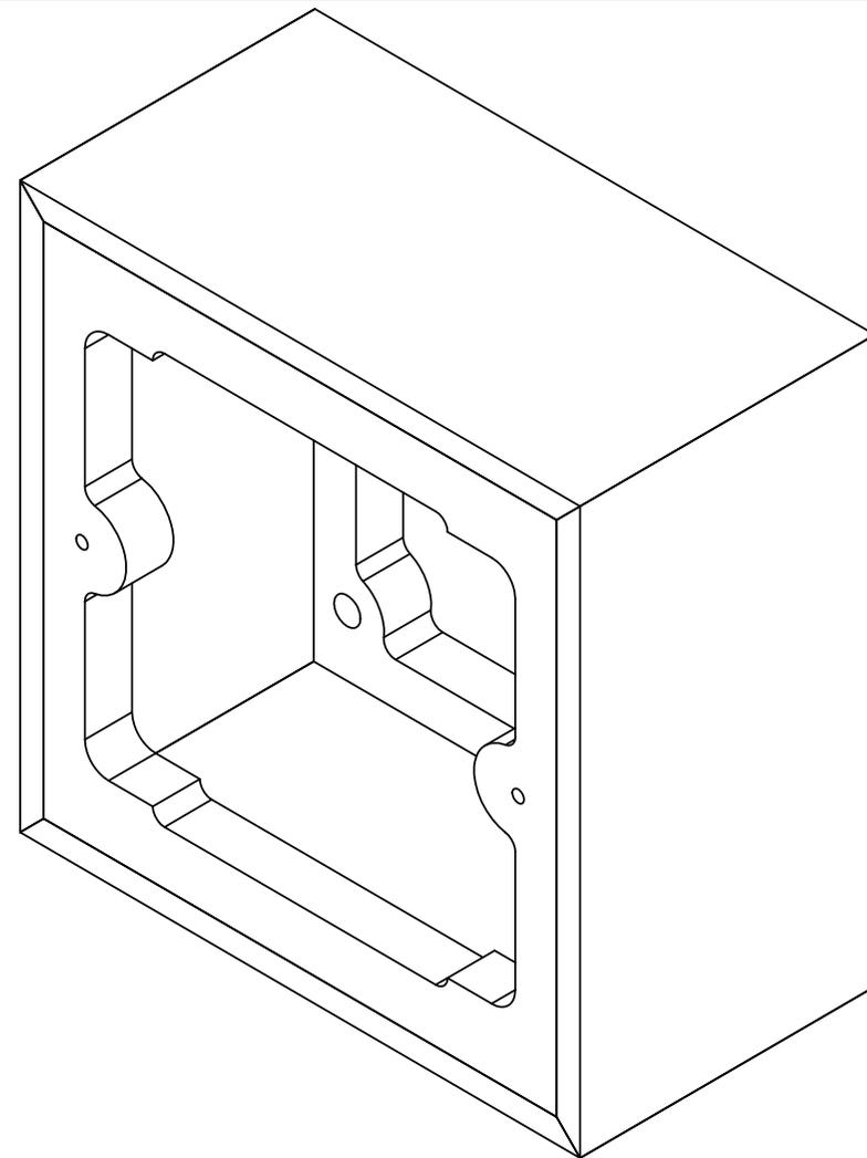
**CVGAUDIO WS-ERC-SL** - Монтажный бокс для накладной установки на стену контроллера CVGAUDIO ERC-1 или CVGAUDIO PW, цвет серебряный
