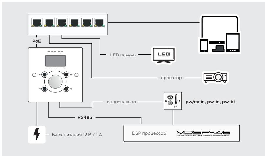
Вариант использования в качестве зональных контроллеров управления для многозонных аудио систем
