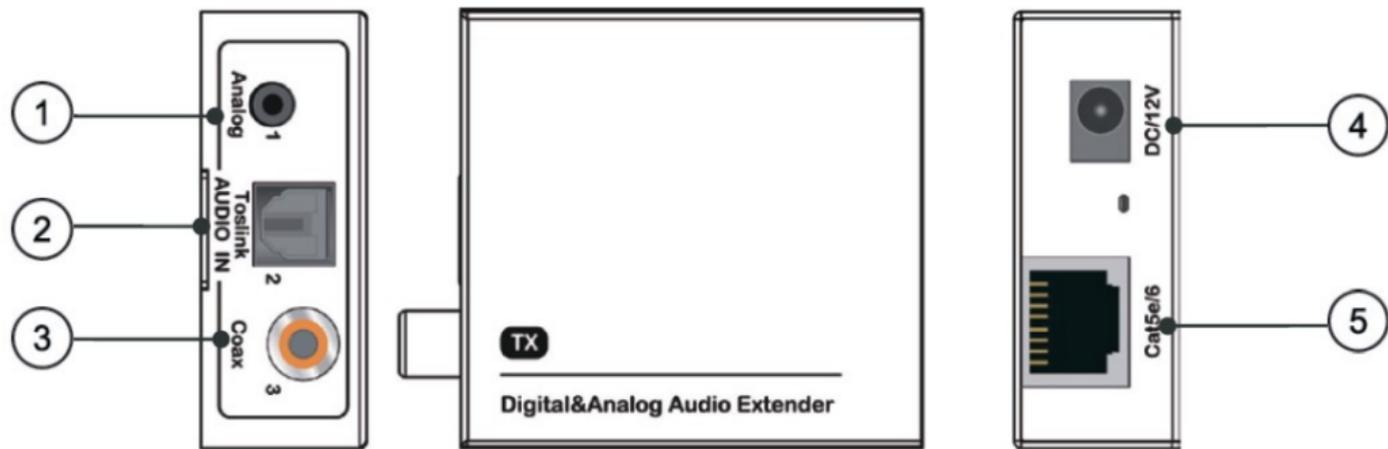
**1. ANALOG:** Входной разъем 3.5мм для подключения источника аналогового аудио сигнала.
