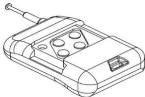
Для нормальной работы пульта дистанционного управления для вашего "FOG900", пожалуйста, полностью выдвиньте антенну, чтобы обеспечить хороший сигнал соединения с приемником. Максимальное расстояние от приемника к пульту дистанционного управления составляет 30 - 50м на открытой местности.
