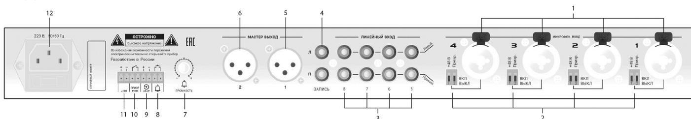
1. «**Микрофонный вход 1-4**» - Предназначен для подключения динамических или конденсаторных микрофонов. (Комбинированный разъем XLR и JACK).
