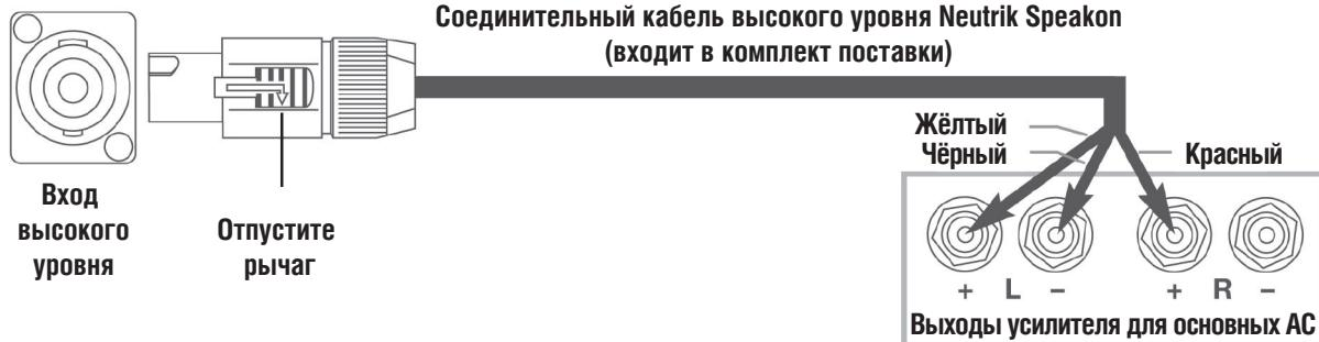
**Подключение к дифференциальным усилителям с симметричным выходом через высокоуровневый симметричный вход.** Используйте стандартную схему подключения, за одним исключением: чёрный провод следует оставить неподключённым. Если у вас появятся вопросы в связи с процедурой подключения, пожалуйста, обратитесь к официальному дилеру REL.
