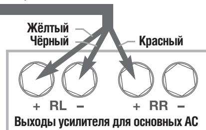
Соединение низкого уровня (разъёма RCA) используется в тех редких случаях, когда соединение высокого уровня невозможно. Подключите вход низкого уровня сабвуфера REL монофоническим кабелем к левому или правому выходу предусилителя. Поскольку на деле звуковые сигналы ниже 35 Гц имеют монофоническую природу, нет необходимости подключать сабвуфер к обоим выходам.
