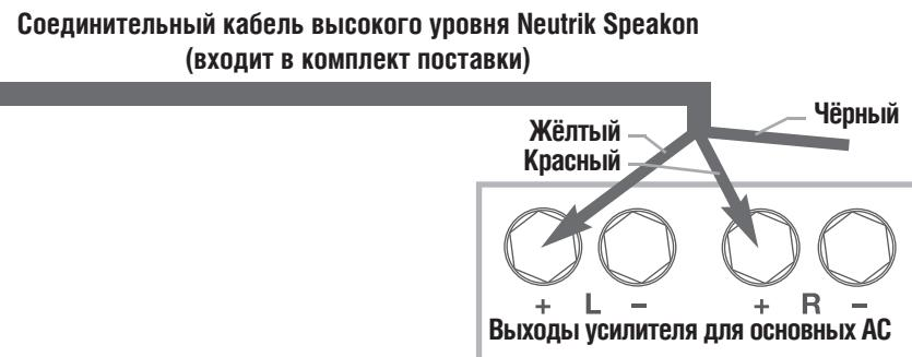
**Примечание:** конструкция сабвуфера T-Zero MKIII позволяет подключать его к цифровым усилителям класса D. При подключении к усилителю класса D следуйте приведённой выше схеме для подключения к дифференциальным усилителям.
