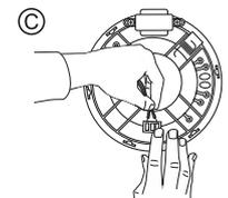
CPA6T имеют самозажимной клеммный терминал на три контакта. Для подключения на необходимую мощность нужно использовать контакт COM (-) и контакт соответствующий выбранной мощности (3W/100V или 6W/100V). Зачистите концы приходящего спикерного кабеля приблизительно на 4-5mm. Нажмите и удерживайте кнопку на клеммном терминале. Затем в открывшийся разъем поместите зачищенную часть кабеля и отпустите кнопку. Проверьте надежность фиксации кабеля.
